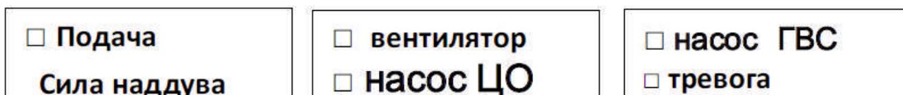
работает до повторного нажатия кнопки ОПЦИИ. Дополнительная опция сила наддува позволяет установить любую скорость вентилятора в ручном режиме.
