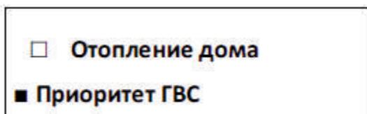
В этом режиме включается насос котла (ГВС), работающего до момента достижения заданной температуры (смотреть главу II.г), тогда выключается насос ГВС и включается насос ЦО.
