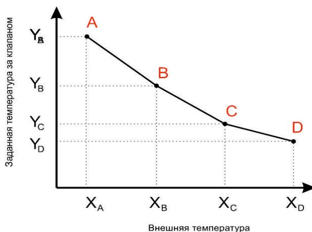
**Кривая отопления** — это кривая, по которой определяется заданная температура контроллера учитываемая наружную температуру воздуха. Кривая отопления в нашем контроллере построена на основе четырёх точек, заданных температур для соответствующих наружных температур. Установка заданных температур должна быть определена для наружных температур воздуха  $-20^{\circ}\text{C}$ ,  $-10^{\circ}\text{C}$ ,  $0^{\circ}\text{C}$  и  $10^{\circ}\text{C}$ .
