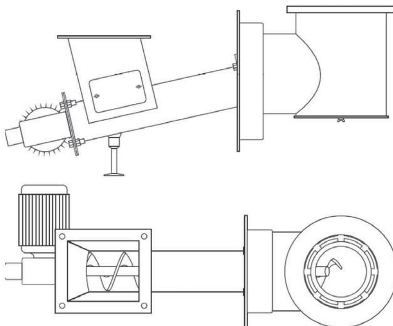
*Конструкция устройства автоматической подачи твердого топлива PSP/SK*
