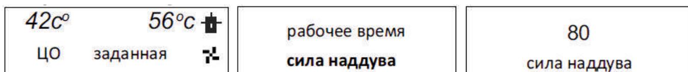
Эта функция управляет скоростью вращения вентилятора. Предел регулировки - 1-100%. Благодаря тому, что вентилятор всегда включается с полной скоростью, можно его запустить при легко запылённом двигателе.
