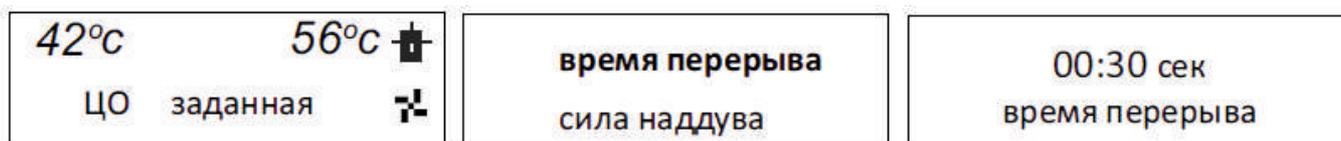
настроен в зависимости от типа топлива. Неправильный подбор рабочего времени и перерыва может привести к неправильной работе котла, то есть топливо может быть не до конца сожжено, а котел может не достичь заданной температуры. Правильный подбор подходящего времени работы и перерыва позволяет работать котлу должным образом.
