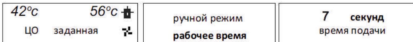
\*Эта функция является активной только для котлов со шнековым питателем. С помощью этой опции можно установить рабочее время подачи топлива, которое зависит от применяемого топлива и типа котла.
