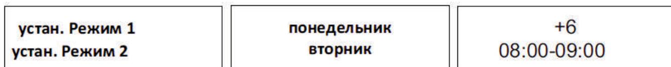
Функция обеспечивает программирование суточных изменений температуры котла. Заданные отклонения температуры заключаются в пределах +/- 10° С. режим 2), или полностью отключает опцию недельное управление. После активации одного из режимов на главном экране контроллера ниже заданной температуры ЦО (в порядке замены с надписью Заданная) отобразится значение актуально установленного отклонения (оно одновременно информирует о том, что недельное управление активно).
