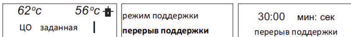
Функция перерыв поддержки используется для установки времени перерыва подачи топлива в режиме поддержки. Неправильная установка времени работы и перерыва может привести к повышению температуры, не желаемому погашению котла или может вызвать воспламенение топлива в баке.
