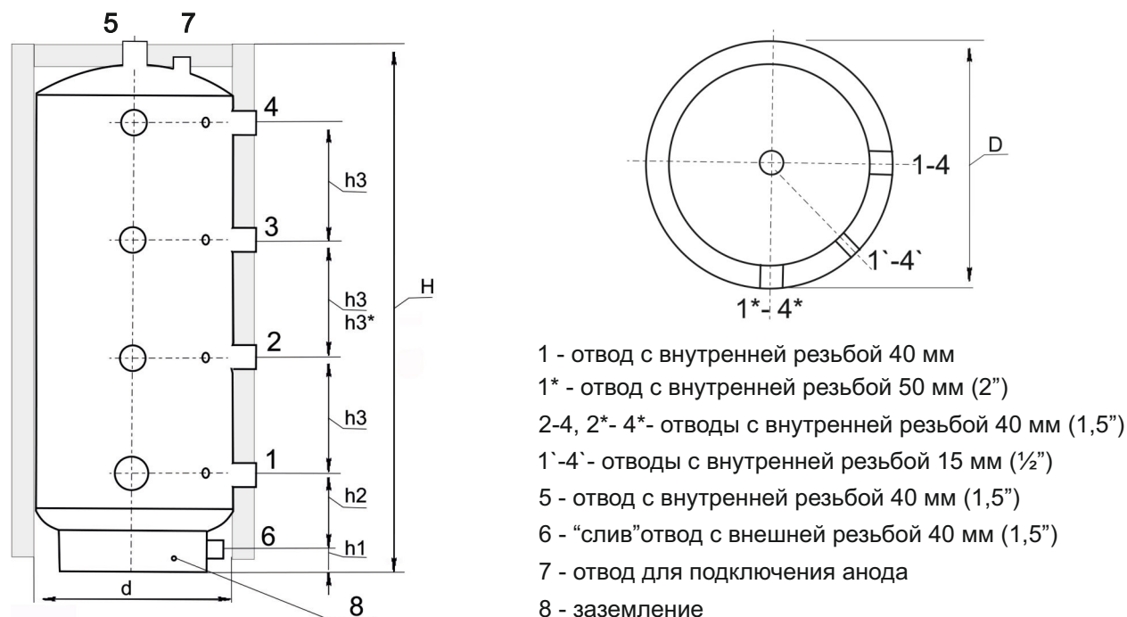
Рисунок 1. Схема подключения теплоаккумулятора серии ТА
