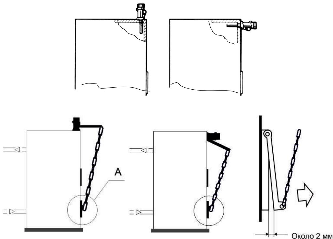
Рисунок 7. Схема закрепления тягорегулятора на заслонке нижней дверцы Котла
